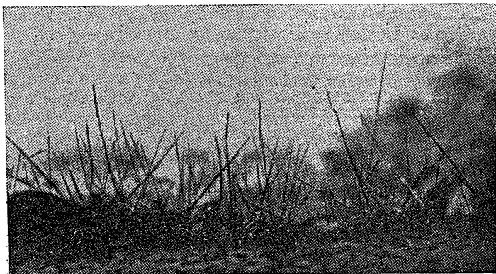
Рис. 9.18. Нитевидные кристаллы (усы) железа, полученные выращиванием из паров путем восстановления железа водородом из бромистого железа при 710^{\circ}\text{C} в железной лодочке.
