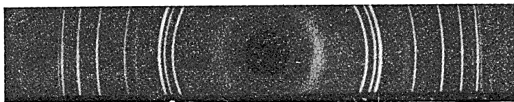
Рис. 2.11. Порошковая рентгенограмма (дебаеграмма), полученная на кристаллах \text{ZnO} .
